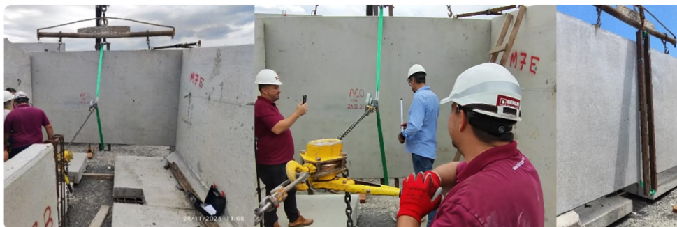
Figura 4 - Conferência altura do ponto de ancoragem e registro da carga aplicada
