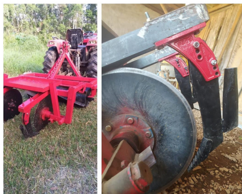
Figura 1: Equipamento montado em tratores de baixa potência, articulado, composto de rolo faca, discos de corte e hastas sulcadoras para operar em SPDH, validado em 2022 com os agricultores do Assentamento Filhos de Sepé, Viamão, RS
